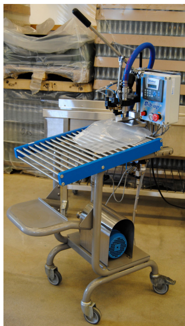
Figur 5. Bag-in-box-fyllare som automatiskt suger ut luft ur påsen och exakt fyller förinställd volym. (Foto: Kimmo Rumpunen).
